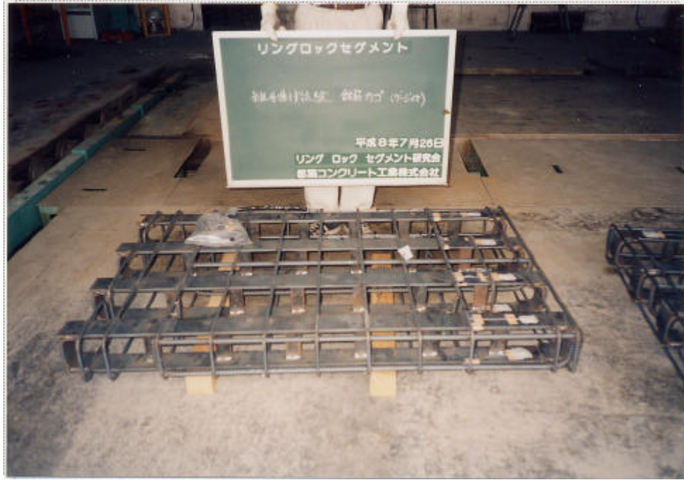
写真 - 1 継手曲げ実験供試体鉄筋籠（ゲージ貼付）
