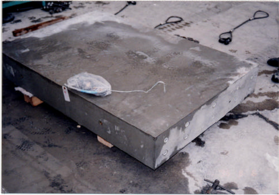
写真 - 3 継手曲げ実験供試体
