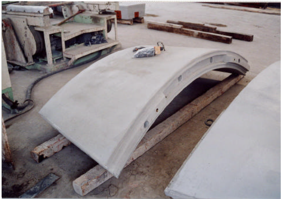
写真 - 2 2 リング載荷実験供試体
