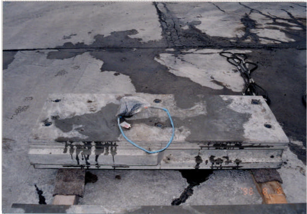
写真 - 1 3 継手せん断実験供試体 (1/2 サイズ)
