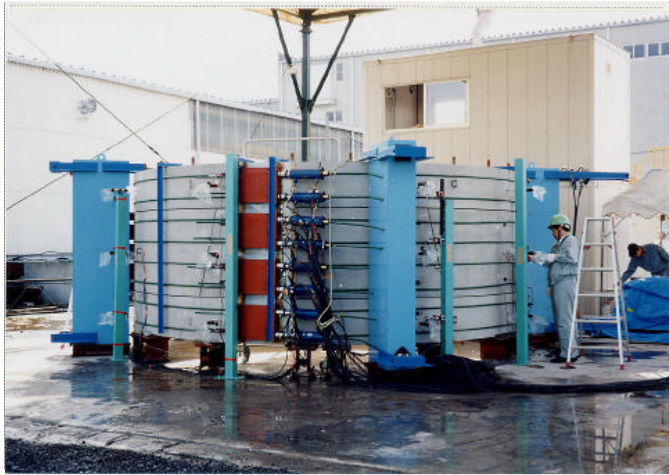
写真 - 2 5 リング載荷実験状況
