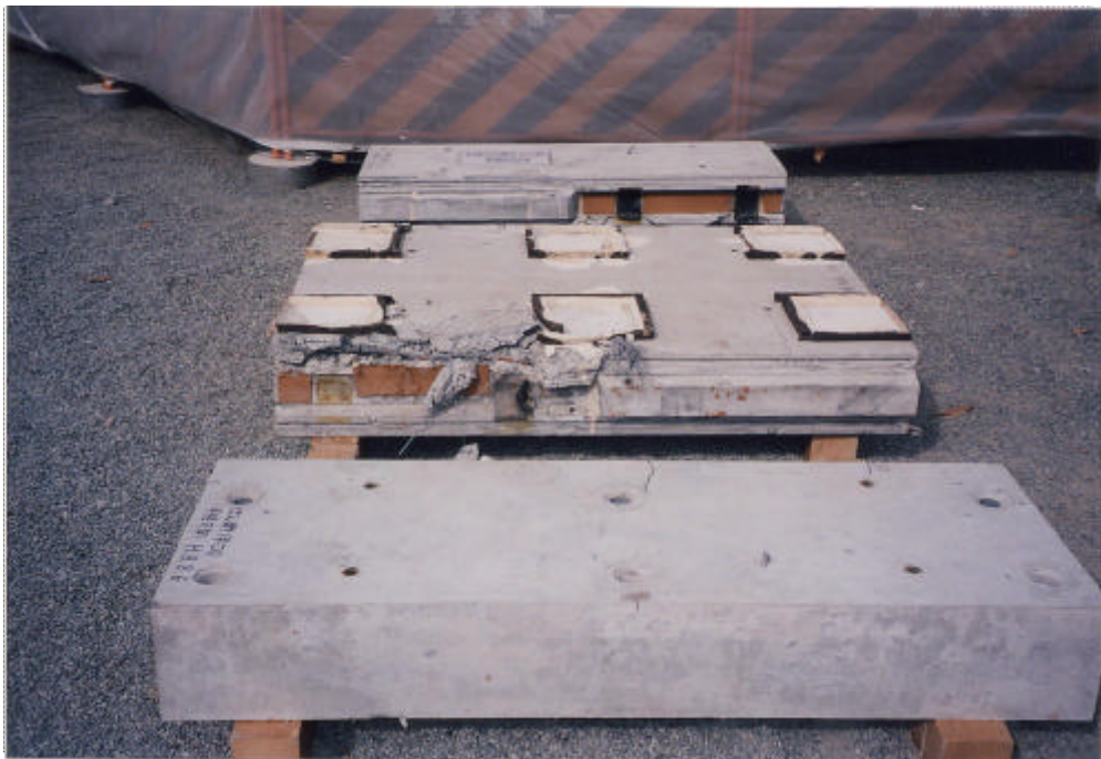
写真 - 1 6 継手せん断実験破壊状況 (半径方向)
