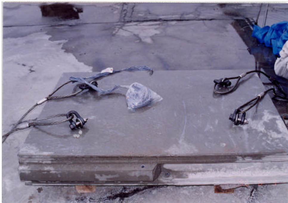
写真 - 1 2 継手せん断実験供試体
