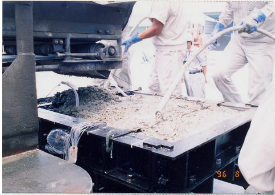
写真 - 1 1 継手せん断実験供試体打設状況
