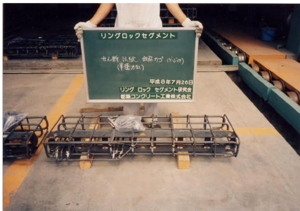
写真 - 8 継手せん断実験供試体鉄筋籠（半径方向：ゲージ貼付，1/2 サイズ）
