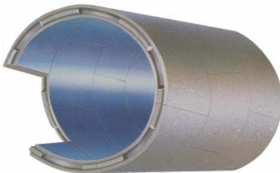
リングロックセグメントによるトンネル覆工
