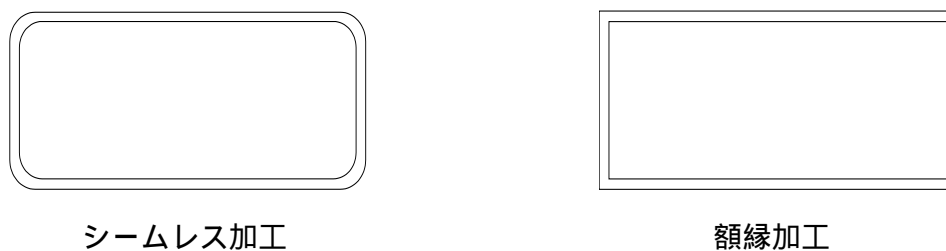
図 2.2.12 シール材の加工
